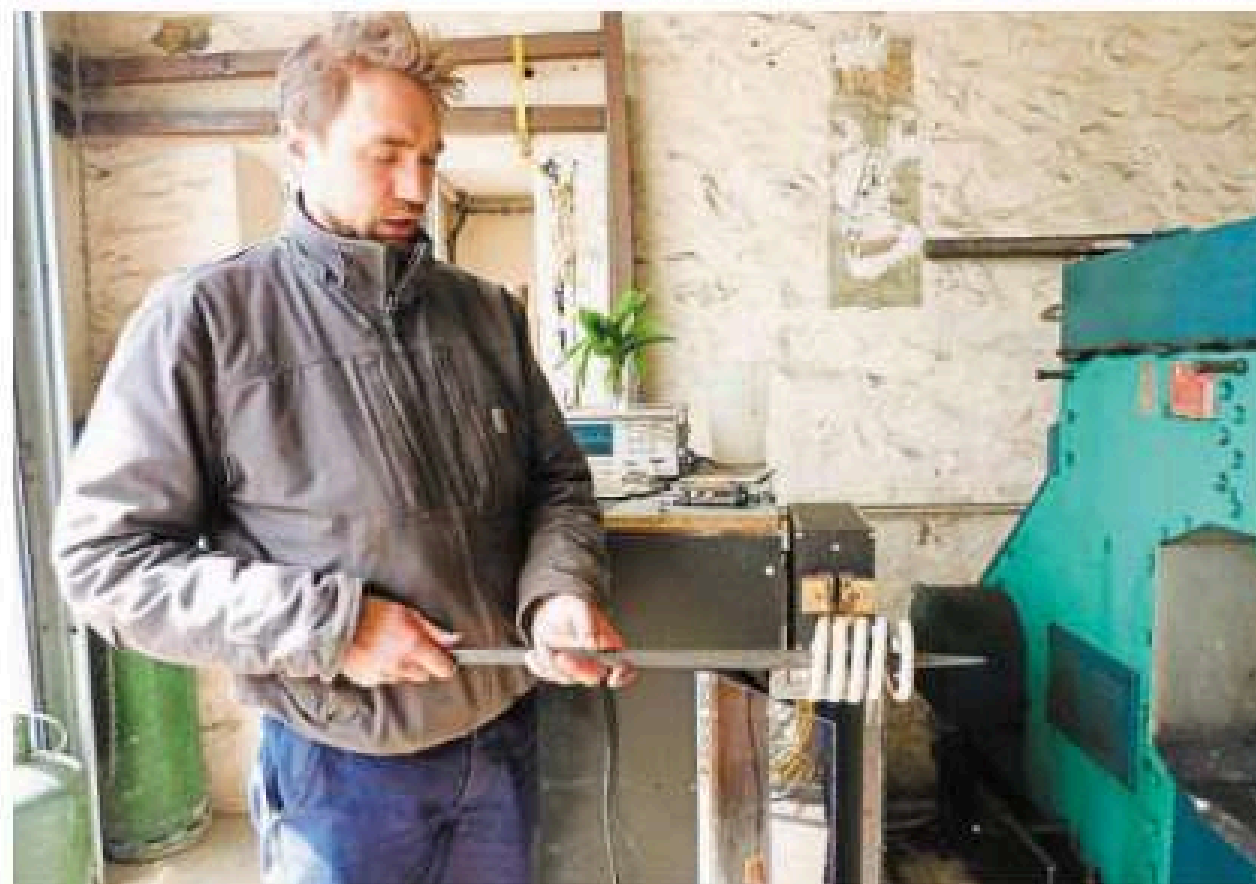
Léo Coutant, Mains d'or 2025, fait une démonstration avec sa nouvelle machine à induction qui permet de chauffer le métal. | PHOTO : OUEST-FRANCE
